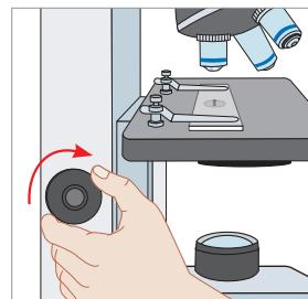
5 張開雙眼，以一眼從目鏡觀察，打開光源及調整光圈的大小，使視野中的亮度適中。
