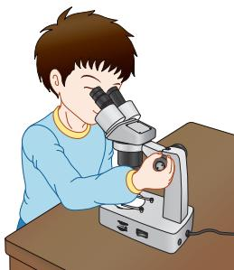
6 閉上左眼，以右眼觀察，轉動右眼目鏡的眼焦調整器，直到看清楚字母，觀察視野中字母方向和實際玻片上字母方向的差異。
