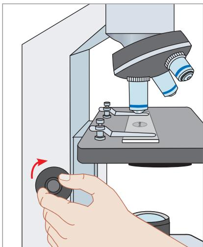
**10** 顯微鏡使用完畢後，應調回低倍率物鏡，取出載玻片，並將載物臺降至最低位置，以防止載物臺鬆動或滑落。最後將顯微鏡整理乾淨後，放回原位。
