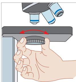
6 慢慢旋轉粗調節輪，當清楚看到玻片中的字體時，再轉動細調節輪，使看到的字體最清晰。
