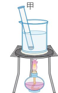
3 將甲試管放入裝有沸水的燒杯中隔水加熱，數分鐘後取出甲試管，待其溫度降至室溫。
