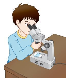
8 鬆開固定夾，用手移動載玻片，觀察視野中字母移動的方向。
