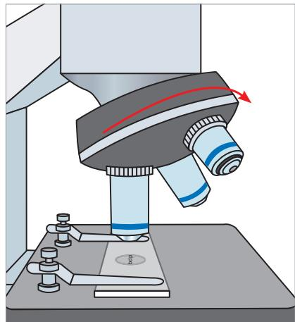
**9** 以較高倍率物鏡觀察時，只需稍微轉動細調節輪，即可看到清晰的物像，如果視野光線太暗，可調整光圈。 筆 紀錄 4
