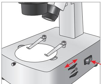
3 將有「bdp」的載玻片平放於載物板上，以固定夾固定。
