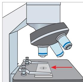
4 轉動粗調節輪，使物鏡和玻片的距離最接近。
