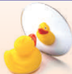
圖4-14 物體在凸面鏡前形成正立縮小虛像
