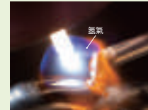
▲圖2-6 高溫焊接時，常以氬氣阻絕金屬與氧氣反應
