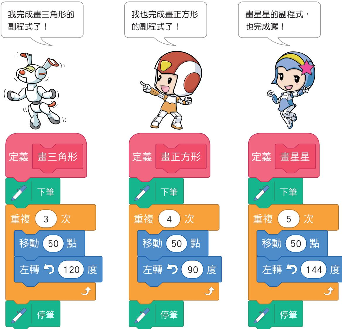
▲圖 4-3 運用副程式使撰寫程式更清楚明瞭（以 Scratch 為例）。
