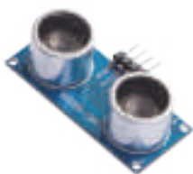
▲圖 5-7 利用程式設定可讓超音波感測器測量與障礙物之間的距離並轉向。
