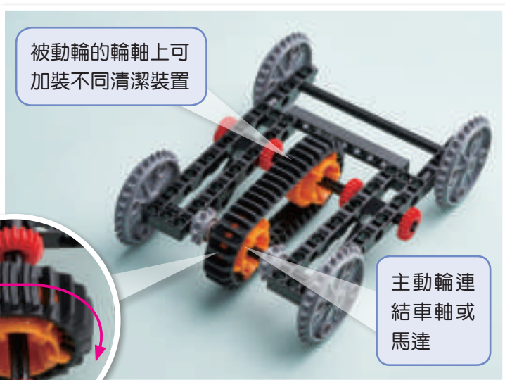
▲ 圖 5-10 藉由撓性傳動可以帶動滾筒旋轉。
