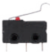
▲圖 5-6 可藉由微動開關的通電與否來控制馬達轉向。
