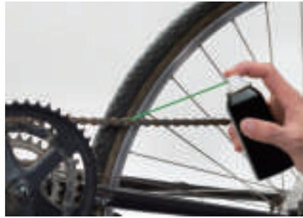
▲ 圖6-12 腳踏車的鏈條添加潤滑油，可以減少機械零件的摩擦
