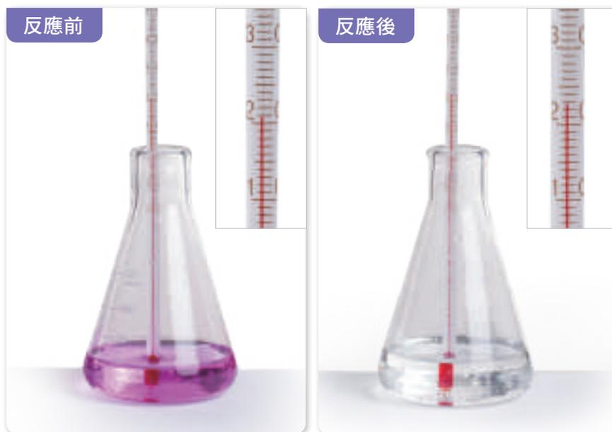
▲ 圖3-18 鹽酸滴入氫氧化鈉水溶液中，會改變溶液的酸鹼性，並且會使溶液溫度上升
