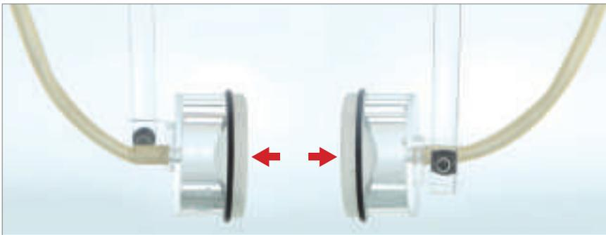
▲ 圖6-20 在水中同樣深度，不論橡皮膜朝向何方，凹陷程度均相同
