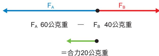
如圖6-5所示，鋼圈兩側以彈簧秤勾住，施於彈簧秤A與B的合力等於施於彈簧秤C的力，因此整體合力為零，達到力平衡的狀態。
