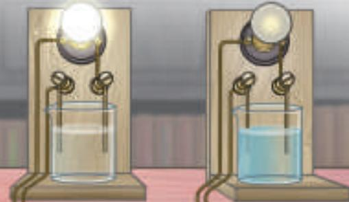
阿瑞尼斯認為當溶液稀釋時，因為水的作用使離子分解出的離子數量增加，所以溶液導電性增強，這個發現證實了不需要通電就能解離出離子。
