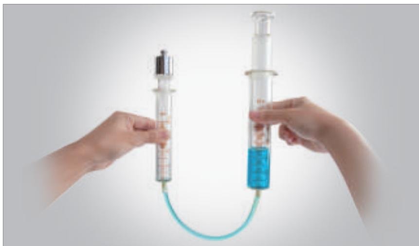
▲ 圖6-25 小針筒活塞上放置砝碼後，可看到小注射筒水面下降，而大針筒水面上升
