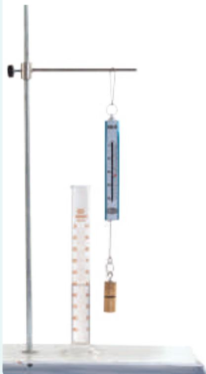
**2** 在100mL量筒中裝一半的水，並將金屬塊的一半浸入水中，記錄此時彈簧秤的讀數，以及量筒中水面的刻度。
