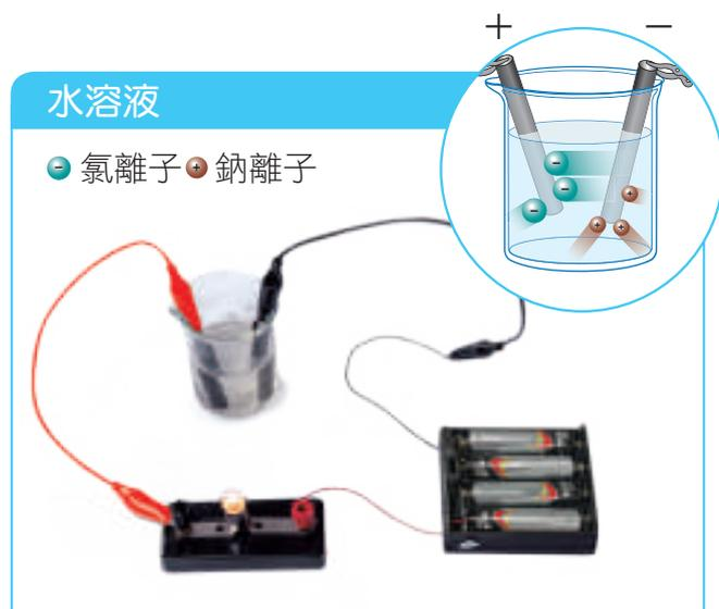
▲ 圖3-4 氯化鈉水溶液中的鈉離子與氯離子可以自由移動，所以能導電
