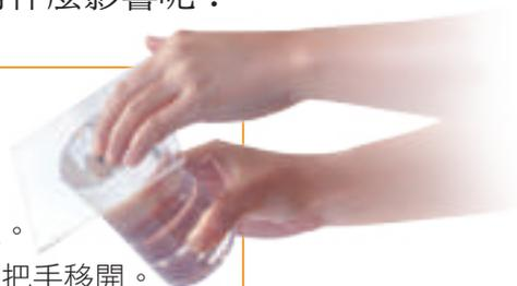
在探討活動6-3中，覆蓋薄塑膠板的水杯，即使杯口朝下，水也不會流出（圖6-27），正是因為有大氣壓力。大氣壓力是由大氣層中空氣的重量造成的，義大利科學家托里切利（Evangelista Torricelli，1608～1647）在西元1643年首次測量出大氣壓力，但隨時間地點不同，大氣壓力也會改變，我們將在緯度45°、溫度0°C的海平面上，可以支撐起76公分高水銀柱的大氣壓力，定義為標準氣壓，稱為**一大氣壓（atm）**（圖6-28），相當於每平方公分上承受約1公斤重的垂直力。
