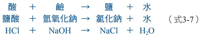
中和反應發生時，鈉離子與氯離子在水中以離子狀態存在，而氫離子與氫氧根離子則結合成水，故酸鹼中和的反應方程式可簡寫成式3-8。
