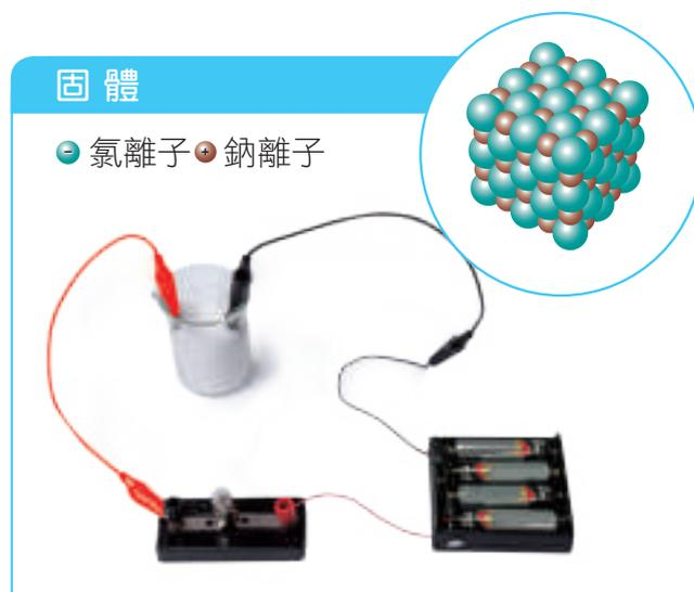
▲ 圖3-5 氯化鈉固體中的鈉離子與氯離子無法自由移動，所以不能導電
