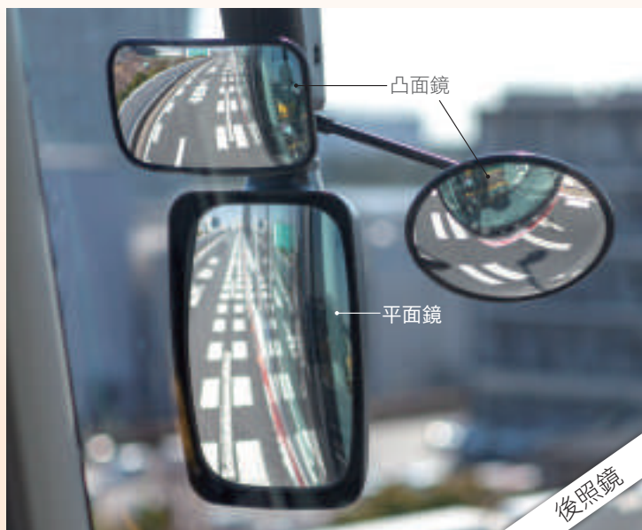
▲ 圖4-15 利用凸面鏡可看到較廣的視野
