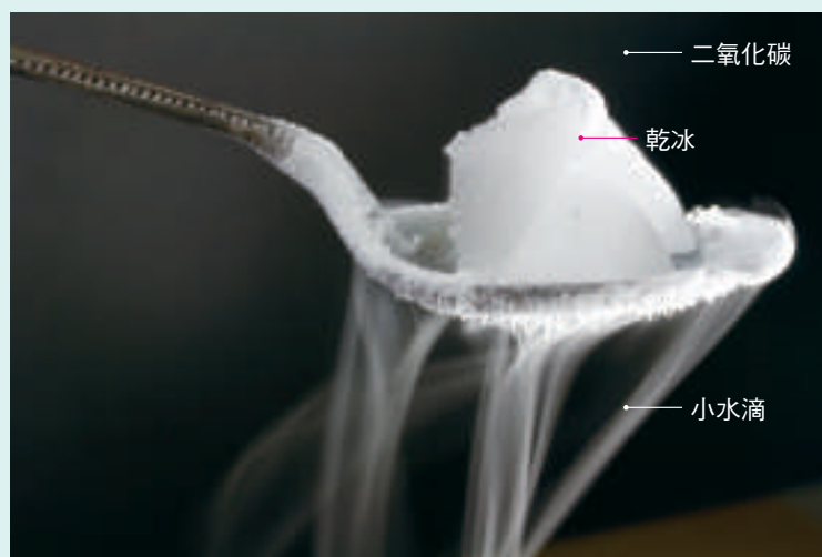
▲ 圖2-7 乾冰昇華時，會使附近的水蒸氣凝結成小水滴，產生白色煙霧的現象
