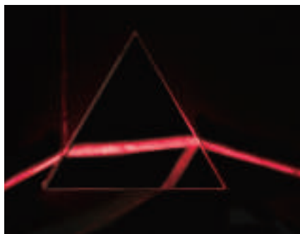
圖4-27 雷射光與陽光通過三稜鏡的差異
