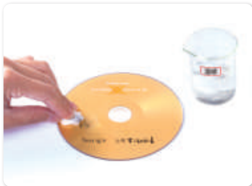
▲ 圖2-11 簽字筆成分無法溶解在水中，卻可以溶解在酒精中
