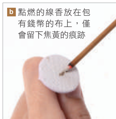
▲ 圖5-12 傳導能力好的錢幣可以迅速將熱傳遞走
