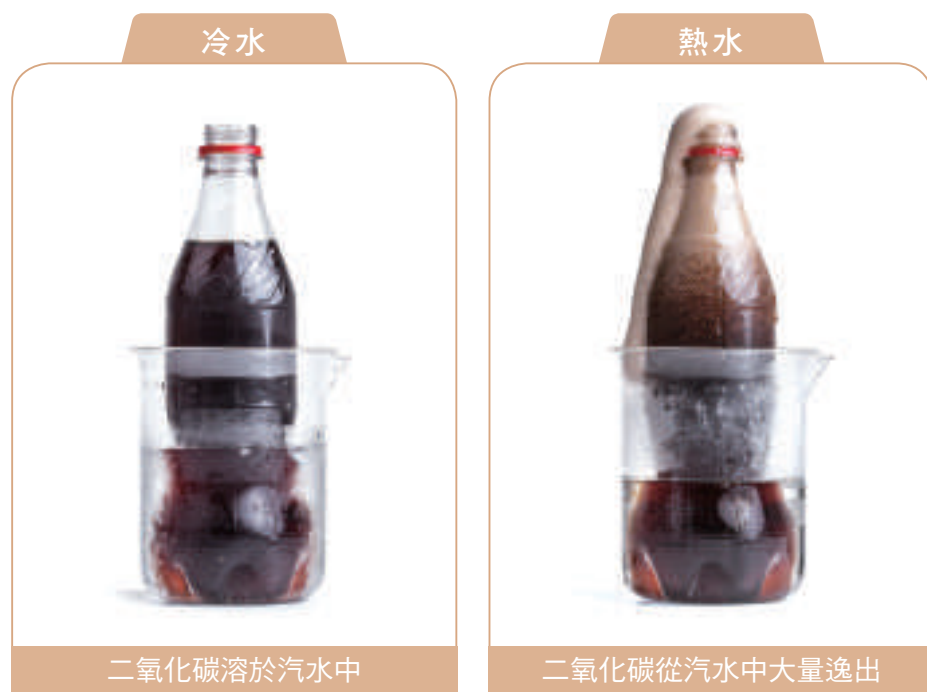
圖2-20 汽水浸泡於冷水和熱水中的情形
