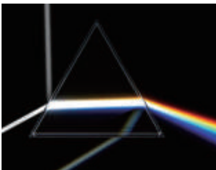
圖4-27 雷射光與陽光通過三稜鏡的差異
