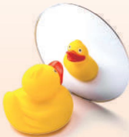
▲ 圖4-14 物體在凸面鏡前形成正立縮小虛像
