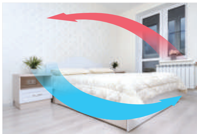
▲ 圖5-17 將暖氣機安裝於室內低處，可使暖氣因熱對流上升，均勻散布在室內
