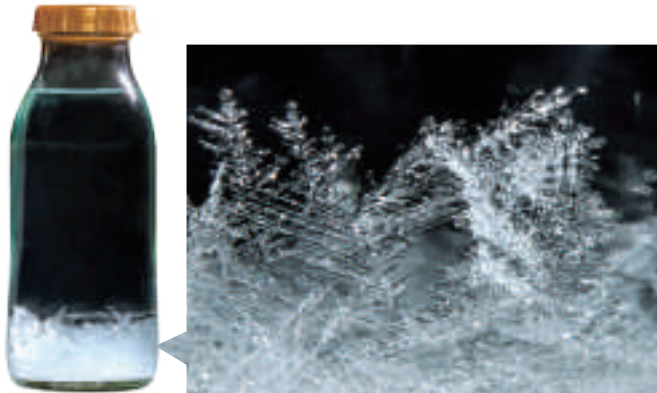
▲ 圖2-23 利用結晶法來得知氣溫的變化
