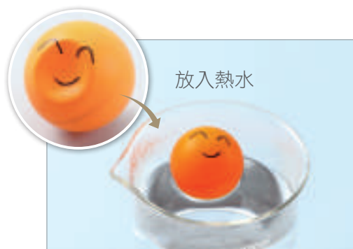
圖5-8 乒乓球內的空氣受熱體積膨脹，可使凹陷處恢復原狀
