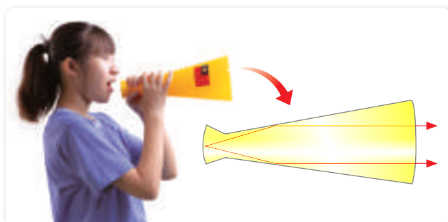
▲ 圖3-23 傳聲筒的傳聲原理
