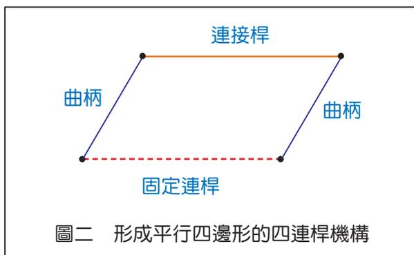
由於飛毯這個四連桿機構的底部固定連桿原本就保持著水平的狀態，所以飛毯本身在迴旋舉昇的過程中也總能隨時保持著水平狀態。
