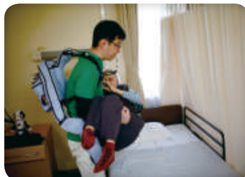
圖1-2-7 外骨骼輔具／日本致力發展機械輔具，照護人員可穿戴輔具，減輕勞力負擔。
