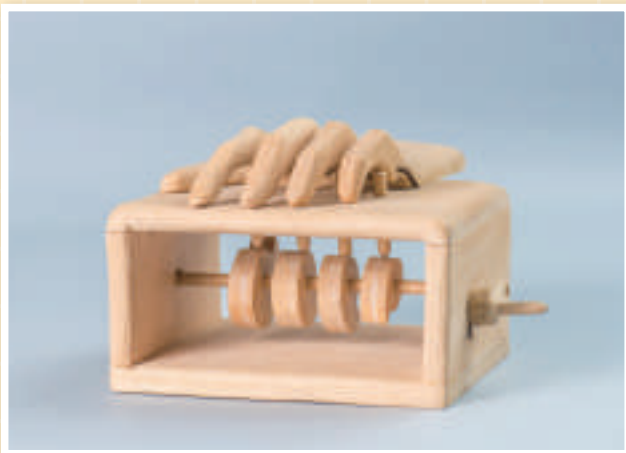
▲ 圖 5-5 結合多顆凸輪或改變擺放的角度，都能產生更生動的效果。
