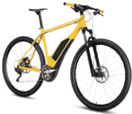
▲圖 4-11 腳踏車架是最簡易的桁架應用。
