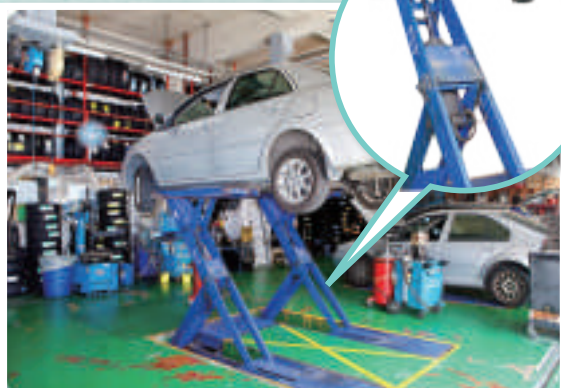
結合油壓裝置的千斤頂，可以讓我們用較小的力量舉起極重的物體。
