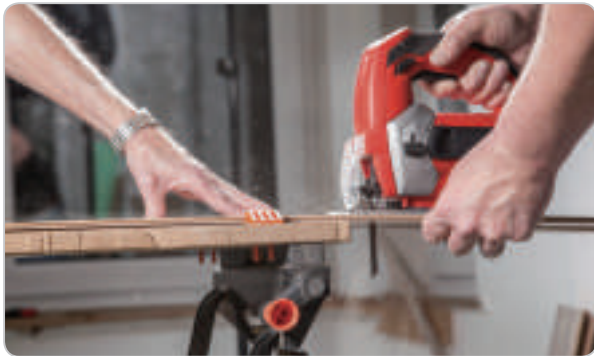
▲圖 4-33 線鋸機鋸條的上下運動。
