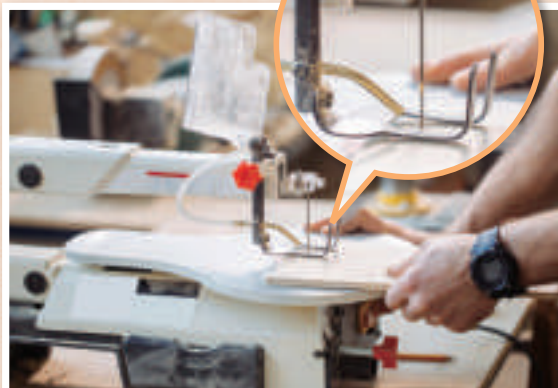
線鋸機可以代替手線鋸，快速地鋸切木頭。
