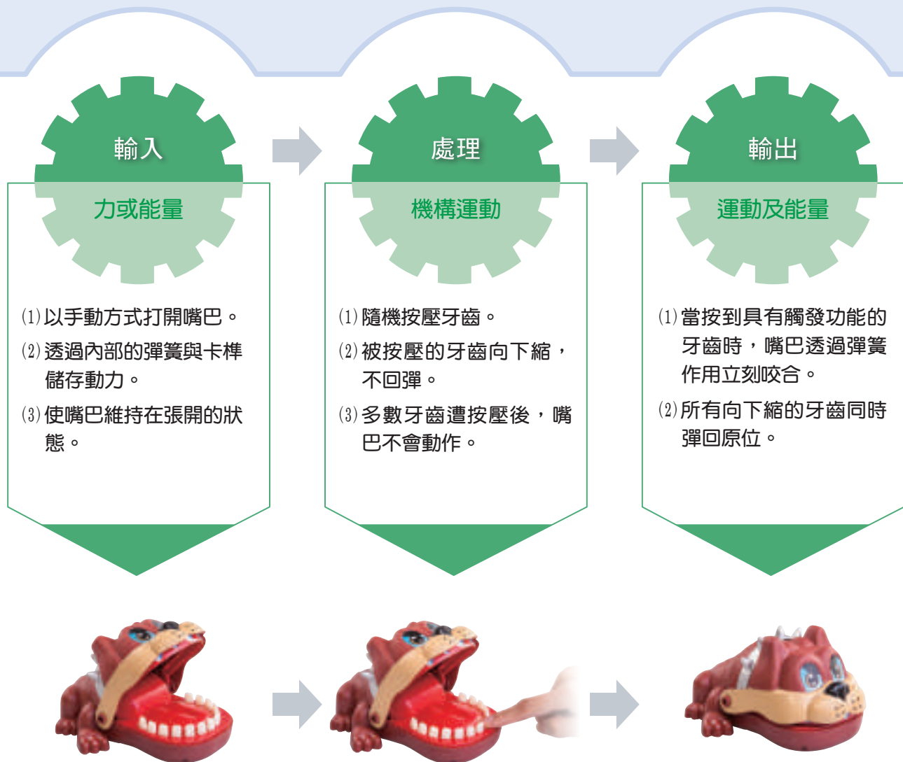
▲圖 4-26 咬人小狗玩具的機械運作過程。
